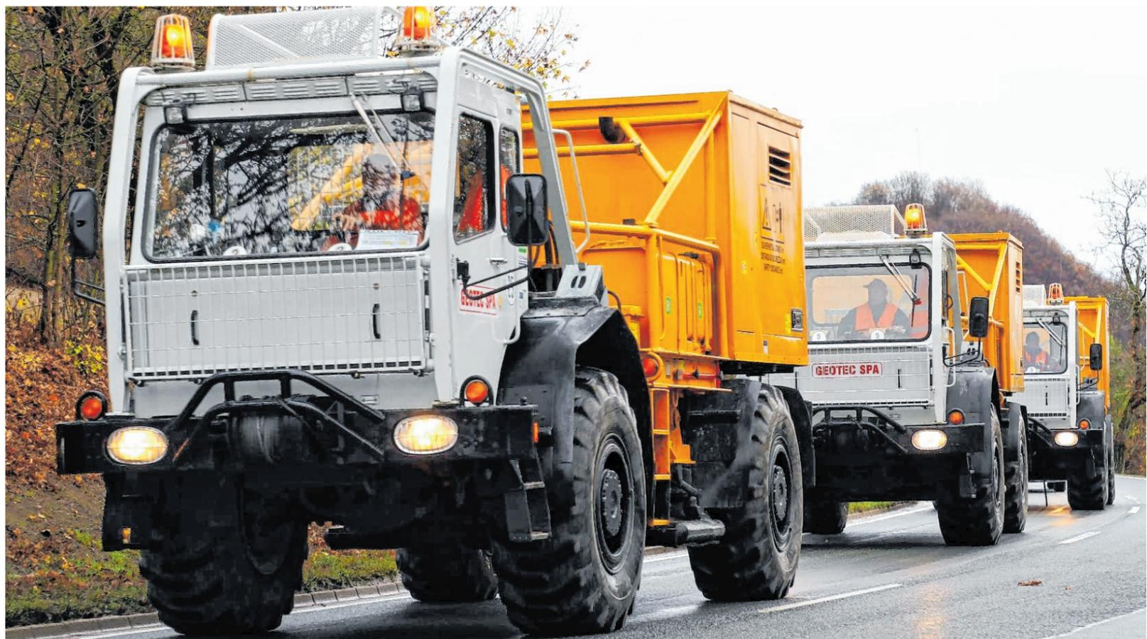
Immer für 16 Sekunden: Gleichzeitig senden die drei Vibrationstrucks Schallwellen aus.
