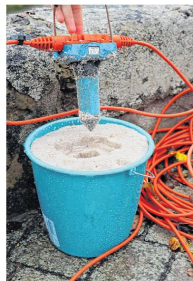
So sehen die seismischen Sensoren aus, die entlang der Untersuchungsstrecke installiert wurden.
