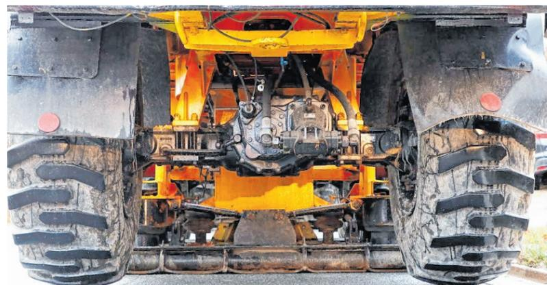
„Es ist ein wenig wie eine Ultraschalluntersuchung beim Arzt“: Zwischen den Reifen werden schwarze Metallplatten auf den Straßenasphalt abgesenkt und dann in Schwingung gebracht.
